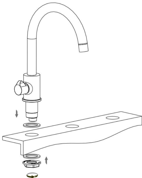
Снимите крепёж в нижней части корпуса смесителя и оденьте прокладку в основание установочного стержня, затем снизу прикрутите крепёж на корпус смесителя.
