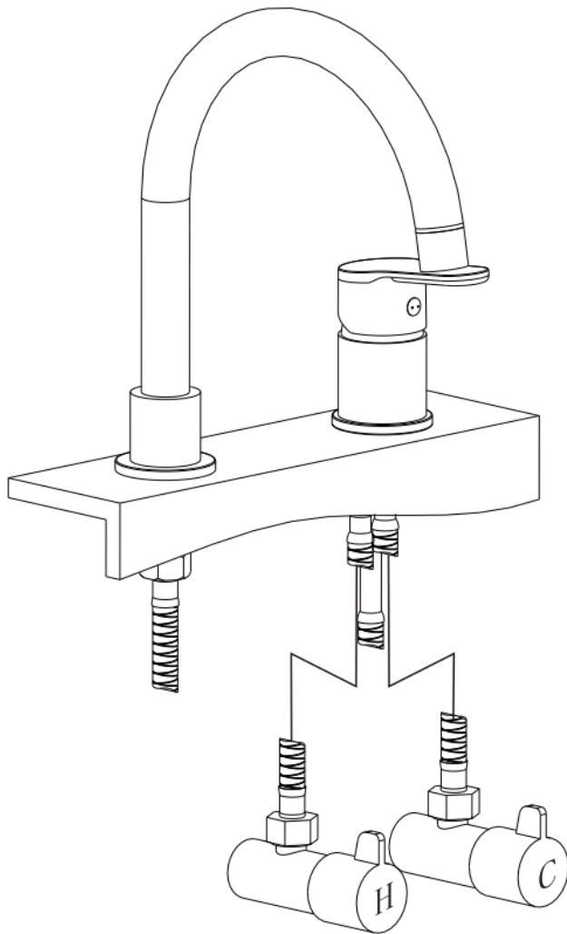
На поверхности, куда устанавливается смеситель, должны быть три сквозных отверстия Ф35мм. Снимите крепёж в нижней части излива и оденьте прокладку в основание установочного стержня, затем снизу прикрутите и затяните гайку на излив.
