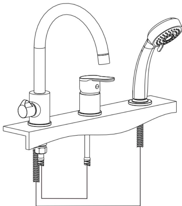
Соедините корпус смесителя с угловыми вентилями гибкими подводками.
