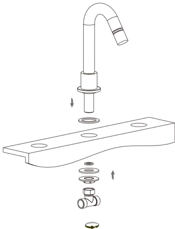
Последовательно снимите с кран-буксы ручку, прижимную гайку, декоративное основание и соедините её с декоративным основанием и прижимной гайкой. Отрегулируйте её направление и положение. Закрутите прижимную гайку. Затем тую затяните гайку, расположенную на кран-буксе, закрепив таким образом кран-буксу на раковине. В конце установите ручку.
