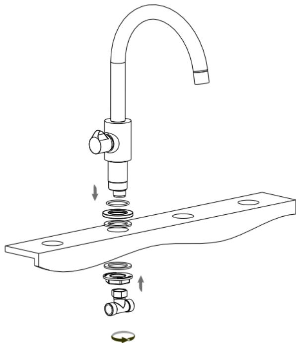
Последовательно снимите с кран-буксы ручку, прижимную гайку, декоративное основание и соедините её с декоративным основанием и прижимной гайкой. Отрегулируйте её направление и положение. Закрутите прижимную гайку. Затем туго затяните гайку, расположенную на кран-буксе, закрепив таким образом кран-буксу на раковине. В конце установите ручку.
