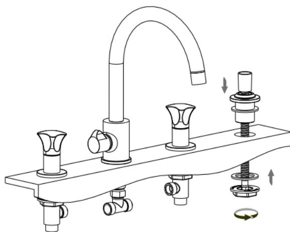
Вставьте в тройник прокладки и прикрутите его к изливу. Потом соедините тройник с кран-бусами гибкими шлангами. Затем соедините излив с лейкой 2-метровым гибким шлангом.
