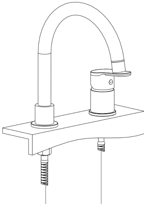
Соедините корпус смесителя с угловыми вентилями гибкими подводками.
