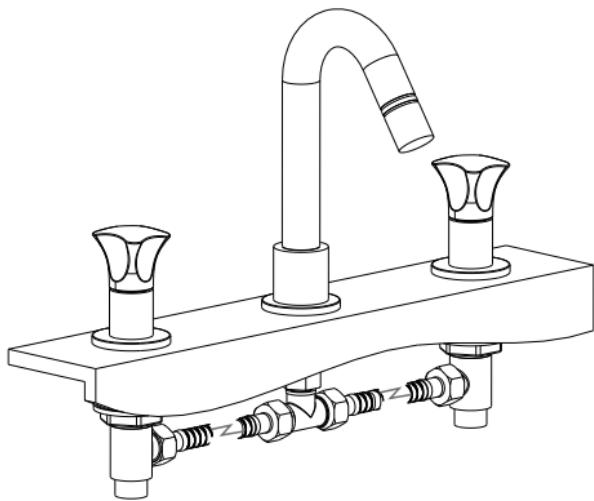
Гибкими подводками соедините кран-буkses с угловыми вентилями. При этом левая кран-букса подключается к горячей воде, а правая к холодной.
