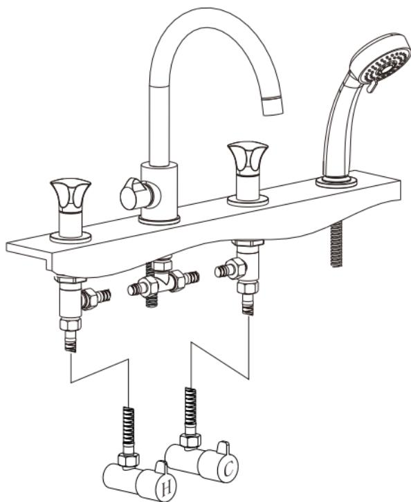
На поверхности, куда устанавливается смеситель, должны быть три сквозных отверстия Ф35мм. Снимите крепёж в нижней части излива и оденьте прокладку в основание установочного стержня, затем снизу прикрутите и затяните гайку на излив.
