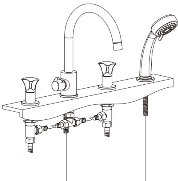
Гибкими подводками соедините кран-буkses с угловыми вентилями. При этом левая кран-букса подключается к горячей воде, а правая к холодной.
