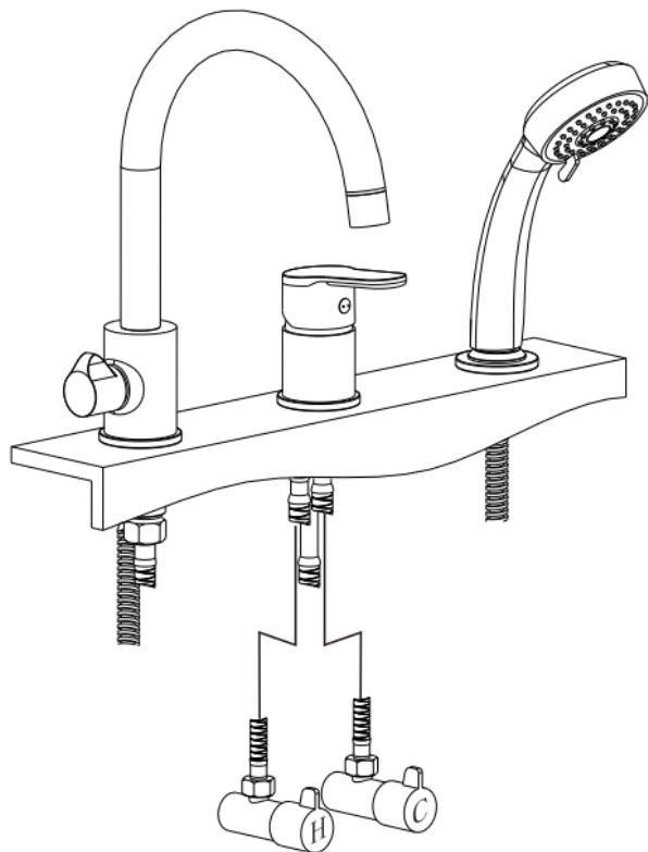
На поверхности, куда устанавливается смеситель, должны быть четыре сквозных отверстия Ф35мм. Снимите крепёж в нижней части излива и оденьте прокладку в основание установочного стержня, затем снизу прикрутите и затяните гайку на излив.
