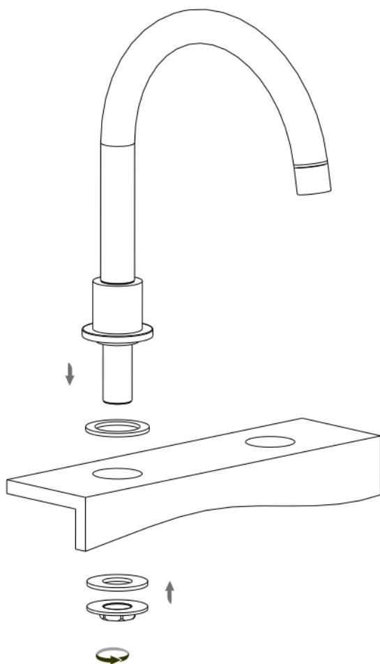
Снимите крепёж в нижней части корпуса смесителя и оденьте прокладку в основание установочного стержня, затем снизу прикрутите крепёж на корпус смесителя.
